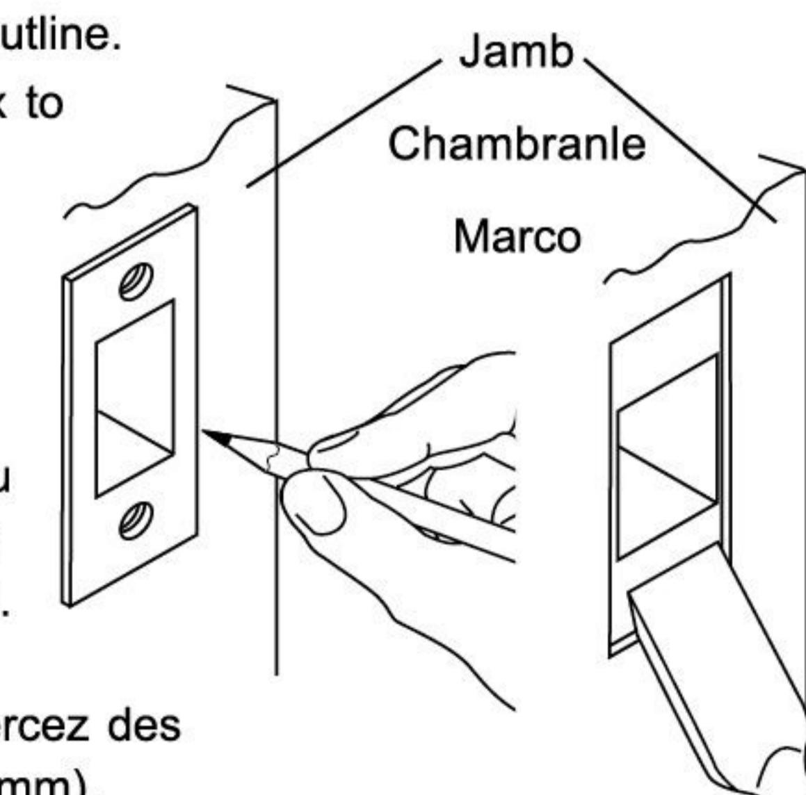
Coloque la caja de cerradura en la jamba, alinee la plancha sobre la caja de cerradura y trace el contorno. Cincele y saque el área trazada con suficiente profundidad como para permitir la instalación de la plancha y de la caja de cerradura al ras con la jamba. Coloque la caja de cerradura y la plancha en la jamba y marque los centros de los orificios para los tornillos. Según las marcas, perfore orificios pilotos de 3/32" de diámetro y 1" (25 mm) de profundidad.
